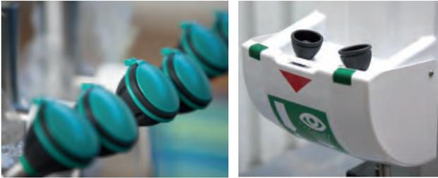
Generell müssen Brauseköpfe mit Staubkappen gegen Schmutz geschützt sein. In Umgebungen mit erhöhtem Schmutzanfall bieten sich Ausführungen mit Deckel an, da so nicht nur die Duschköpfe, sondern auch das Umfeld der Augendusche immer sauber ist. Die Betätigung erfolgt durch Herunterziehen des Deckels.
