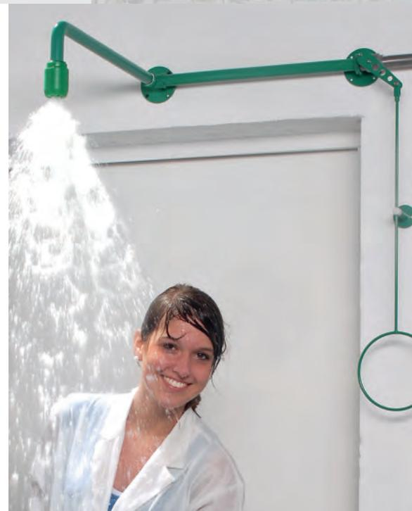
In der Industrie haben sich nach Auffassung der FSP-Tech® GmbH für Körperduschen in Betrieben und Umschlaganlagen Volumenströme von > 60 Litern/Minute bewährt, da im Gegensatz zu Laboranwendungen die Gefahrestoffmengen deutlich höher liegen können. Die Wasserabgabe muss für mindestens 15 Minuten gewährleistet sein.
